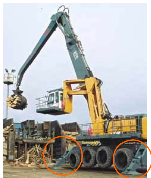
Carregador Liebherr com sapatas em destaque (Foto: Tony Kryzanowski)
